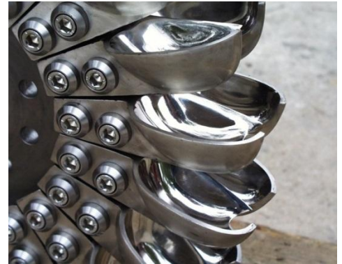
Abbildung 11: Laufrad mit gut sichtbarer Schneide, www.hydrohrom.cz
