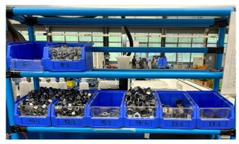
somit nur mit wenig Aufwand sehr viel bewirken können. Auf dem Bild rechts ist ein Regal zu sehen in den Muttern gelagert werden. Mit diesen Behältern können wir die Muttern (welche in grossen Mengen weggeworfen werden) von dem Gewerbeabfall trennen und sie sind zugleich sortiert, falls sie erneut verwendet werden. Dieses System benötigt zwar ziemlich viel Platz aber wir können damit viel für die Umwelt machen.
