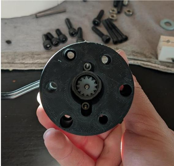
Motor mit M3 Schrauben montiert
